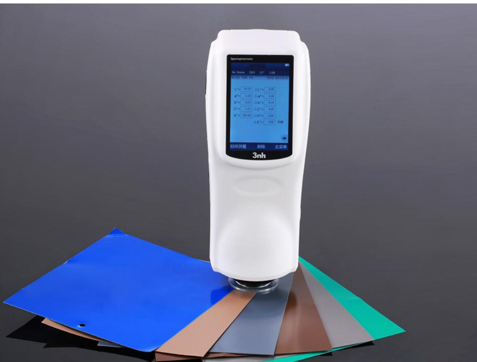
Высококачественный спектрофотометр для контроля цвета, соответствует стандартам CIE, ISO, ASTM, DIN. Корпус модели можно описать как эргономичный и привлекательный, благодаря небольшому размеру удобно помещается в руке во время измерений.
